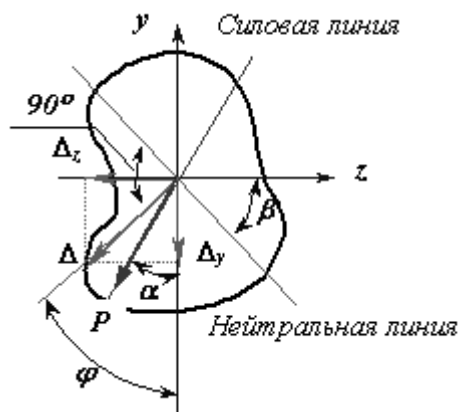
Рис.7.13. Перемещение при косом изгибе
