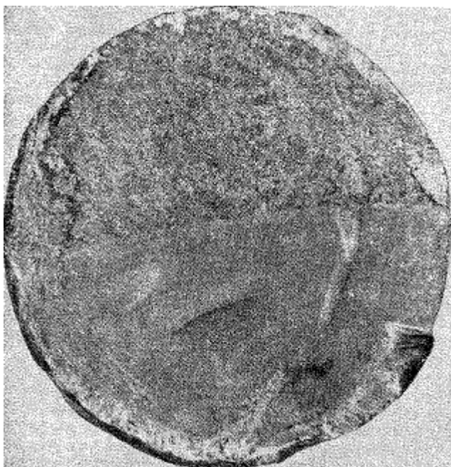
Рис.4. Характерные признаки усталостного разрушения
