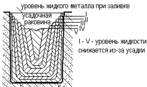
Рис. 2.2. Усадочная раковина
