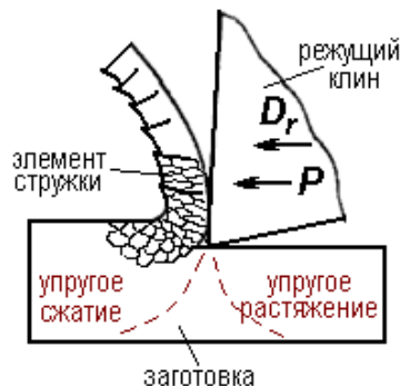
Рис. 5.1. Процесс образования стружки
