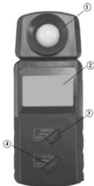
Рис. 10. Описание элементов устройства люксметра LMI-20: 1 – поворотный датчик освещенности; 2 – ЖК-дисплей; 3 – переключатель диапазонов измерений; 4 – переключатель для включения, выключения прибора, удержания показаний на дисплее
