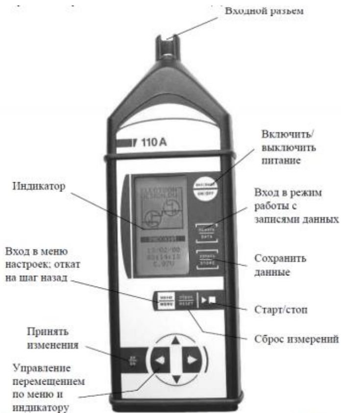
Рис. 4. Внешний вид и описание клавиш шумомера ОКТАВА-110А
