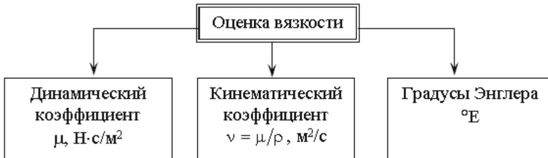
Рис. 1.10. Способы оценки вязкости жидкости
