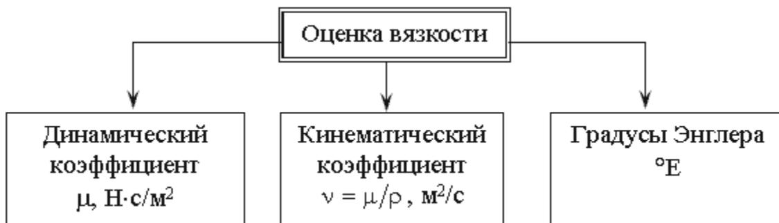
Рис. 1.7. Способы оценки вязкости жидкости
