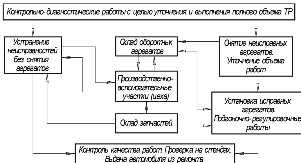
Примерная схема технологического процесса ТР автомобилей
