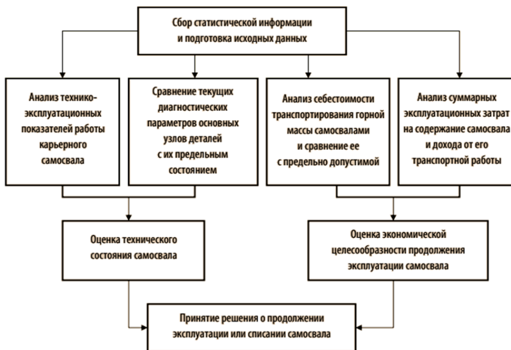
Рис. 1. Структура методики определения продолжения эксплуатации или списания карьерного самосвала
