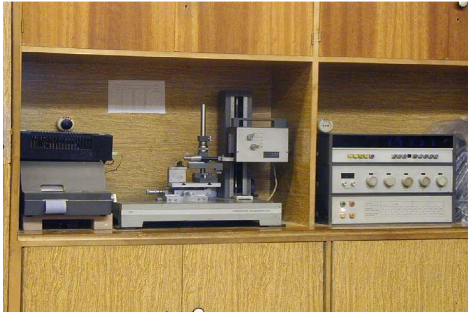
Рис.1.3. Общий вид профилографа-профилометра
