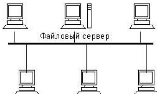
Рис. 5.4. Шинная топология
