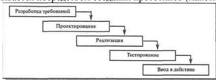
Рис. 5.1. Каскадная модель ЖЦ ИС
