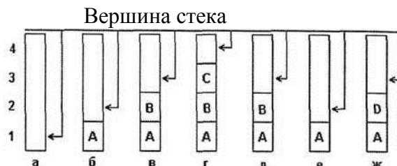
Рис 4.1. Включение и исключение элементов из стека.
