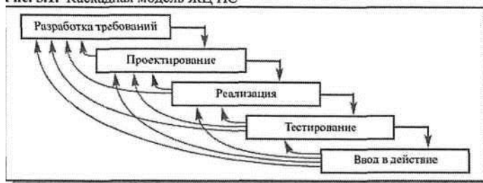
Рис. 5.2. Поэтапная модель с промежуточным контролем
