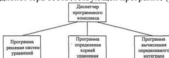
Рис. 4.1. Пример структурной схемы программного комплекса
