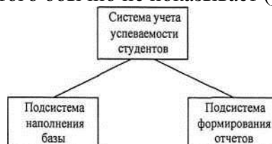
Рис. 4.2. Пример структурной схемы программной системы
