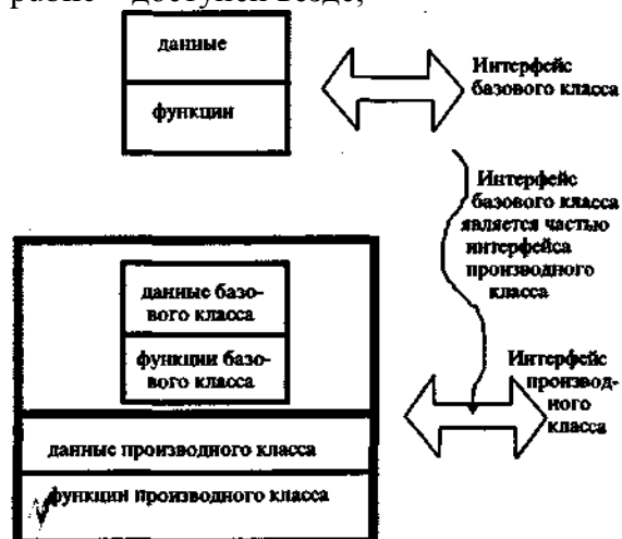
Рис. 5.3. Принцип наследования обеспечивает общность интерфейса базовых и производных классов
