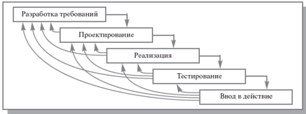
Рис. 3.2. Позапная модель с промежуточным контролем
