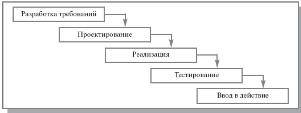
Рис. 3.1. Каскадная модель ЖЦ ИС
