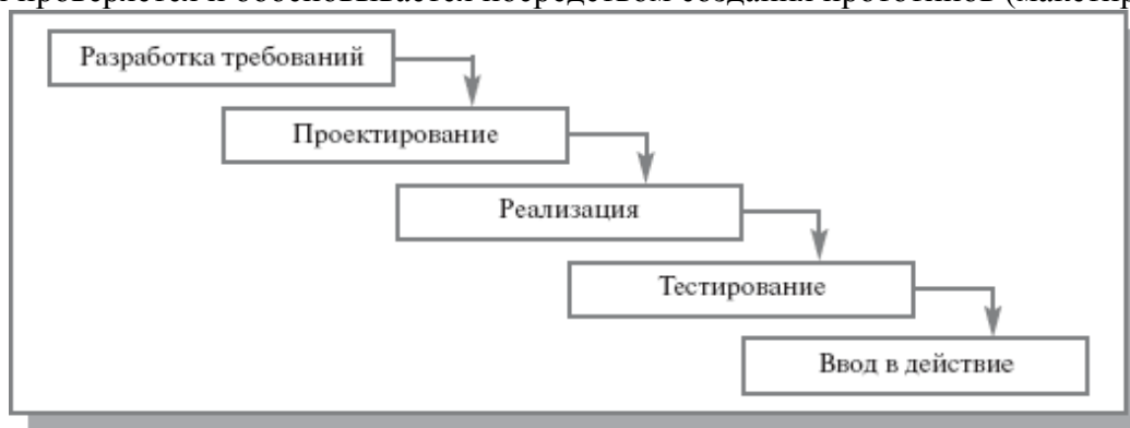
Рис. 3.1. Каскадная модель ЖЦ ИС
