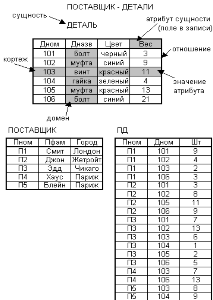
Рис. 8.10. Пример реляционной базы данных
