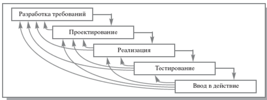
Рис. 3.2. Поэтапная модель с промежуточным контролем
