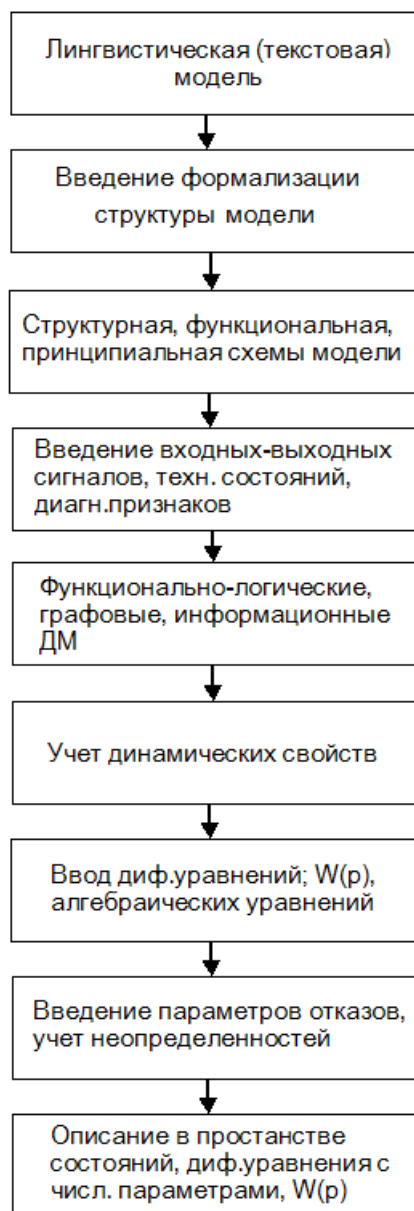
Рис. 26. Иерархия диагностических моделей.
