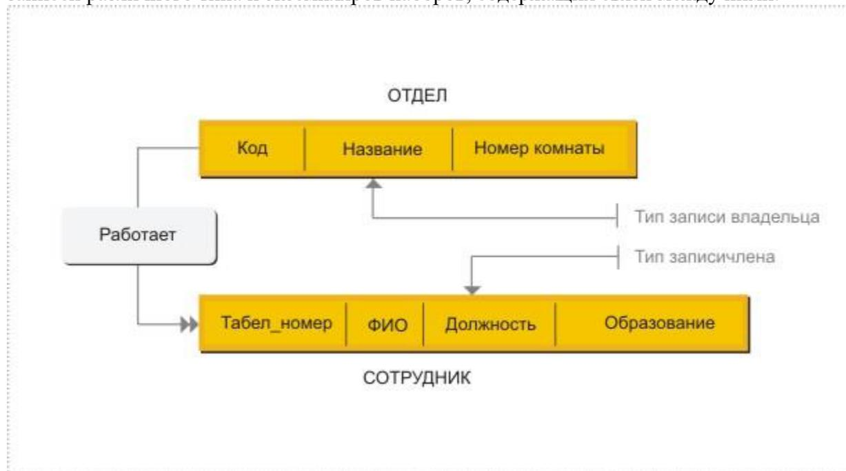
Рис. 3.5. Набор **Работает** между двумя типами записей **Отдел** и **Сотрудник**
