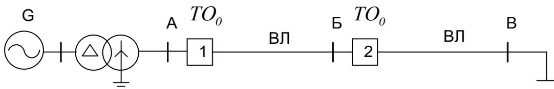
Селективность ТО<sub>0</sub> так же как и селективность обычных ТО обеспечивается ограничением зоны их действия, т.е. самой настройкой (определяющей их ток срабатывания).
