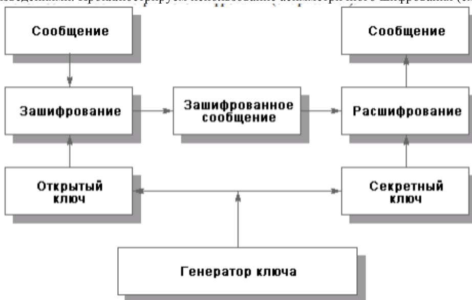
Рис. 8.1. Использование асимметричного метода шифрования
