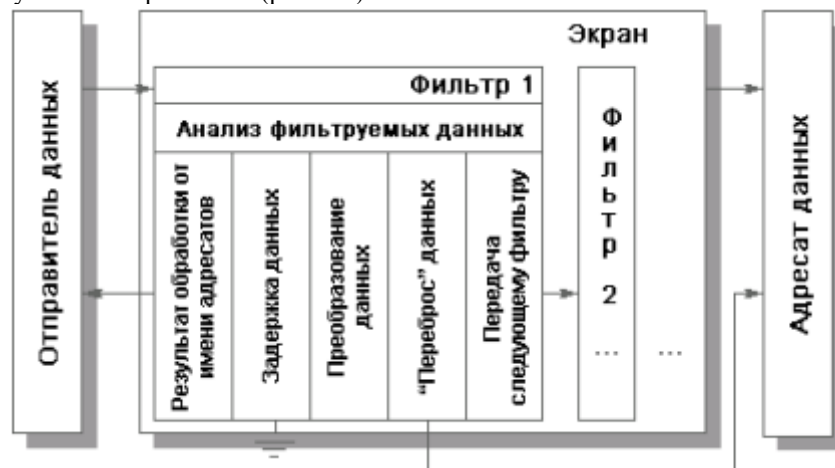
Рис. 9.2. Экран как последовательность фильтров.
