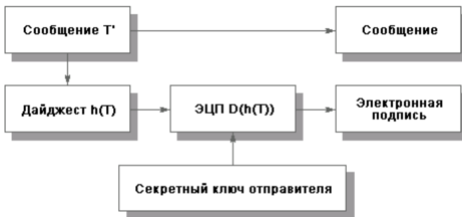
Рис. 8.4. Выработка электронной цифровой подписи
