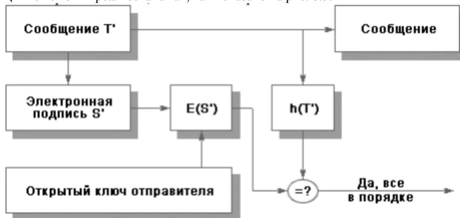
Рис. 8.5. Проверка электронной цифровой подписи.
