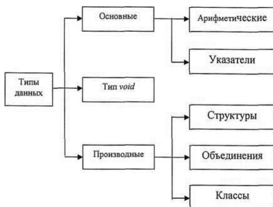
Рис. 2 Структура типа данных языка Си++
