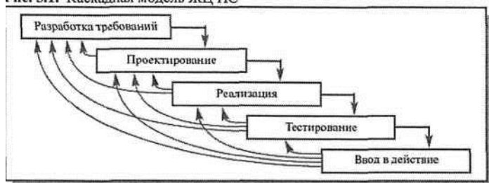
Рис. 5.2. Поэтапная модель с промежуточным контролем
