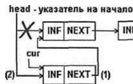
Рис.5.6. Вставка элемента в начало 1-связного списка Удаление элемента из списка.
