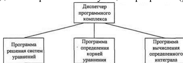
Рис. 4.1. Пример структурной схемы программного комплекса
