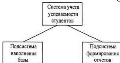
Рис. 4.2. Пример структурной схемы программной системы
