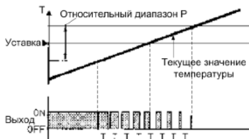
Рис.2. Принцип работы выхода ТК в режиме П-регулятора
