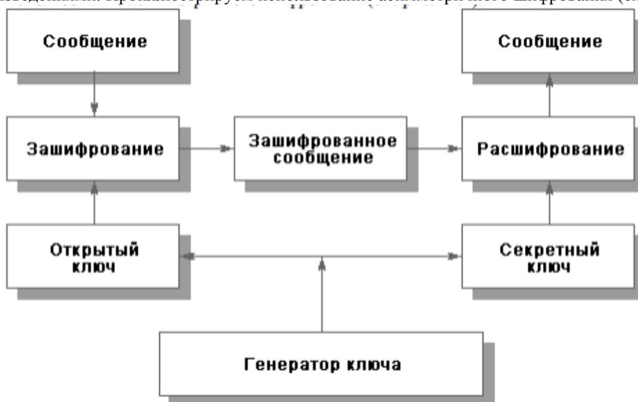
Рис. 8.1. Использование асимметричного метода шифрования
