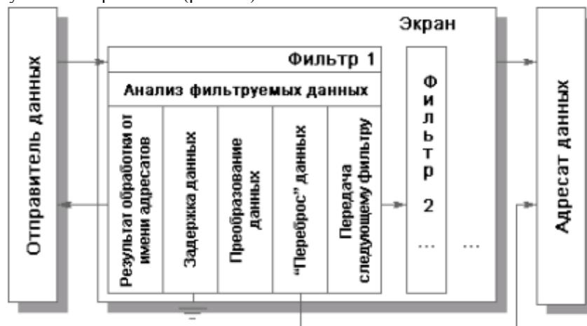
Рис. 9.2. Экран как последовательность фильтров.
