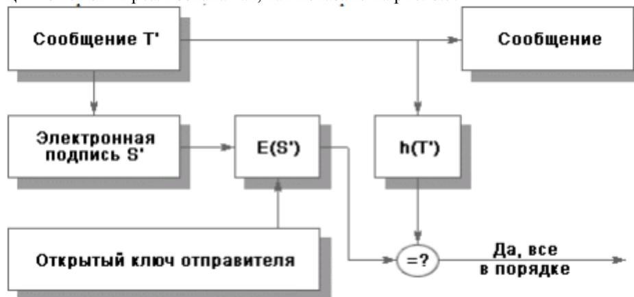
Рис. 8.5. Проверка электронной цифровой подписи.
