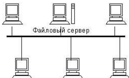
Рис. 5.4. Шинная топология
