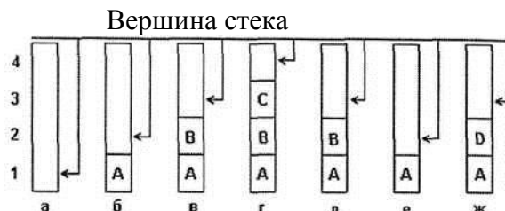
Рис 4.1. Включение и исключение элементов из стека.
