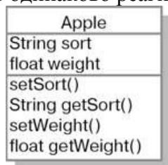
В соответствии с UML (Unified Modelling Language - унифицированный язык моделирования), класс имеет следующее графическое представление.
