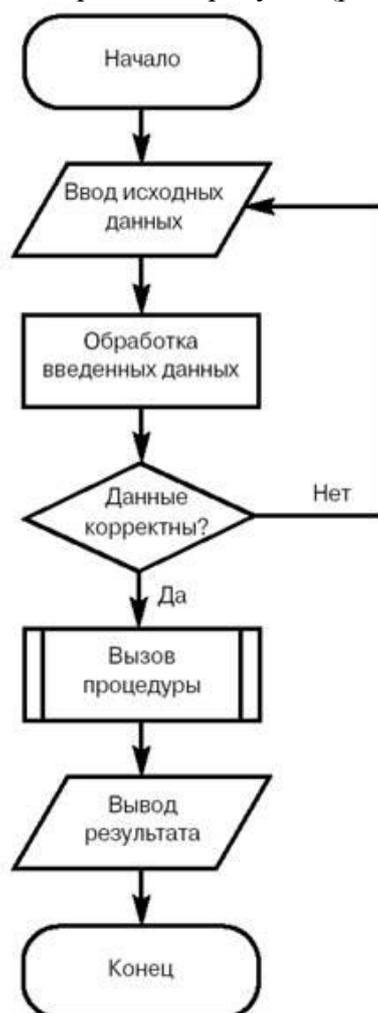
Рис. 2.1. Пример блок-схемы.
