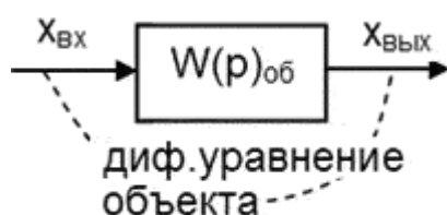
Рис. 1. Схема исследования объекта управления.
