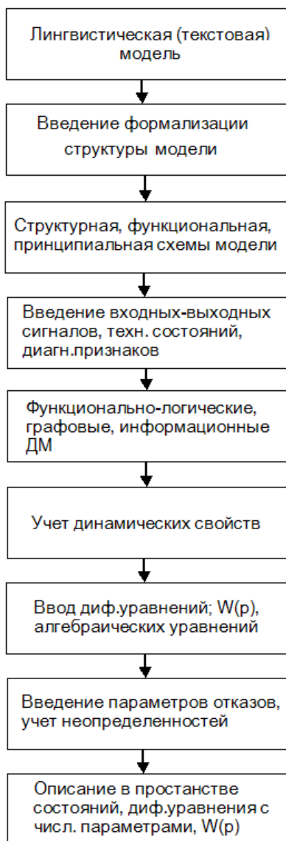
Рис. 26. Иерархия диагностических моделей.
