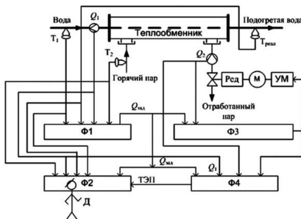
Рис. 1.2. Автоматизированная информационно-управляющая система процессом нагрева в теплообменнике
