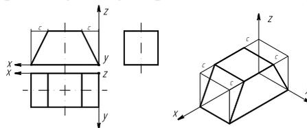
Рис. 8. Чертёж и изометрия параллелепипеда с отсечёнными углами.
