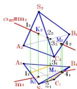
Определение точек пересечения прямой линии  $m$  с поверхностью пирамиды определено следующим образом:
