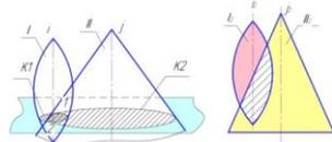
Наиболее общим методом нахождения линии пересечения двух поверхностей является метод посредников, при котором исходные поверхности пересекаются третьей (вспомогательной) поверхностью или плоскостью – посредником. Рассмотрим взаимное пересечение поверхностей в случае, если исходные поверхности обе являются поверхностями вращения; поверхность. Вращения и многогранной поверхностью; двумя многогранными поверхностями.
