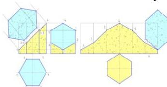
Так как каждое ребро усечено плоскостью, то их высоты также берутся с фронтальной плоскости проекций.
