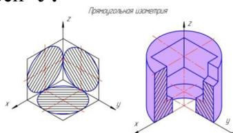
При построении прямоугольной диметрической проекции сокращение длин по оси **Y** принимают вдвое меньшим, чем по другим.
