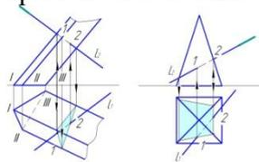
Рассмотрим пример с правильной пирамиды. Требуется определить точки пересечения прямой  $l$  с поверхностью пирамиды. Заданную прямую  $l$  заключаем во вспомогательную фронтально проецирующую плоскость. Эта плоскость, пересекая четыре ребра пирамиды, образует в сечении четырехугольник. Стороны построенного сечения пересекается с прямой  $l$  в искомых точках 1 и 2.
