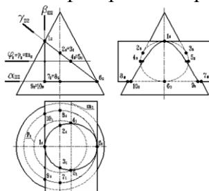
Поверхность призмы является проецирующей по отношению к фронтальной плоскости проекций, следовательно, на этой плоскости проекций линия пересечения совпадает с проекцией основания призмы – треугольником.
