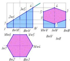
Если секущая плоскость является плоскостью общего положения, то, также определяют точки пересечения ребер многогранника и секущей плоскости. Первым этапом решения подобной задачи является заключение каждого ребра во вспомогательную, проецирующую плоскость-посредник. Следующим этапом определяется линия пересечения заданной секущей плоскости и плоскости-посредника.
