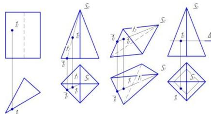
Неизвестные проекции точек, расположенных на поверхностях наклонных призм и пирамид определяют, исходя из условия принадлежности точки соответствующей грани, являющейся отрезком плоскости (точка принадлежит плоскости, если она принадлежит прямой, расположенной в этой плоскости)
