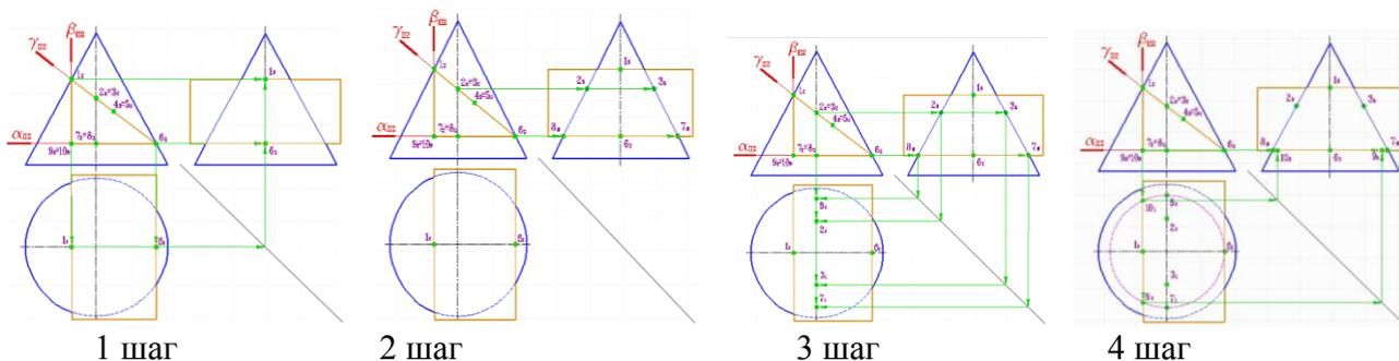
1 шаг – выделяем точки, которые следует определить: точки 1, 9 и 10 вертикальной секущей плоскости; точки 1, 2, 3, 4, 5 и 6 наклонной секущей плоскости; точки 6, 7, 8, 9 и 10 горизонтальной секущей плоскости.
