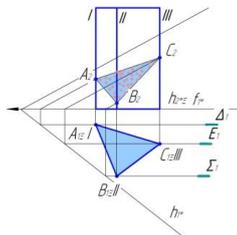
След-проекция  $\Delta_1$  проходит через горизонтальную проекцию ребра I. Плоскость  $\Delta$  пересекается с заданной секущей плоскостью общего положения по фронтальной прямой, которая пересекается с ребром I в точке A ( $A_1 A_2$ ).
