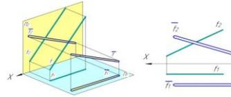
**Тема: Задание и проекции плоскости на комплексном чертеже. Плоскости общего положения, уровня, проецирующие. Точка; прямая в плоскости. Взаимное положение прямой и плоскости, плоскостей.**
