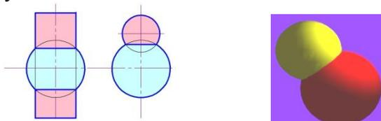
В этом случае одна из многочисленных осей сферы совпадает с осью поверхности вращения (такие поверхности называют соосными). Линия пересечения (окружность) располагается в плоскости, перпендикулярной общей оси.
