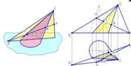
Пересечение прямой линии с наклонным конусом.
