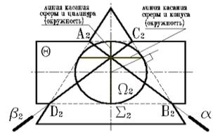
**Пример 1.** Рассмотрим пример на определение линии пересечения поверхностей прямого кругового конуса и сферы. Задачу можно решать и на одной из плоскостей проекций, в данном случае – фронтальной.
