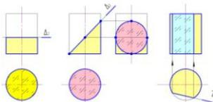
При построении линии пересечения секущей плоскости с поверхностью прямого кругового цилиндра выделяют опорные точки:
