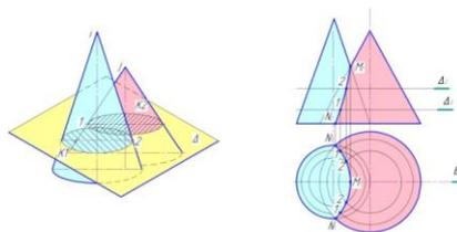
Линия пересечения на фронтальной плоскости проекций  $\Pi_2$  является видимой, если она видима на фронтальных проекциях обеих пересекающихся поверхностей. Линия пересечения на горизонтальной плоскости проекций  $\Pi_1$  является видимой, если она видима на горизонтальных проекциях обеих пересекающихся поверхностей.
