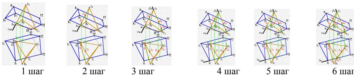
У пирамиды участвуют в пересечении 2 ребра: ребро  $A$  и ребро  $C$ ; а у призмы участвует в пересечении ребро  $C$ .
