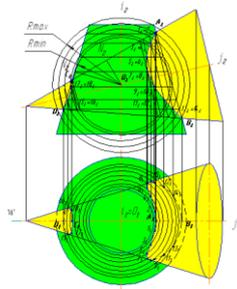
На горизонтальную плоскость проекций точек линии пересечения проецируем на соответствующие их траектории, рассматривая их как точки, принадлежащие и вертикальному конусу в том числе.
