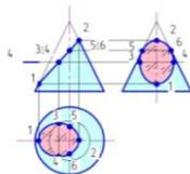
Точки 1 и 2 – самая нижняя и самая верхняя точки сечения; точки 5 и 6 – точки профильного очерка. Точки 3 и 4 определяем с помощью одного из носителей точек. В данном примере выбрана траектория движения – окружность. Полученные точки на каждой из проекций соединяем плавной линией.
