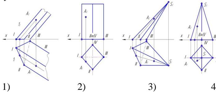
1) На поверхности наклонной призмы точка  $A$  принадлежит грани I-II и некоторой прямой, принадлежащей этой грани, которая проходит параллельно направлению ребер и через точку I на стороне основания. Фронтальная проекция вспомогательной прямой проходит через проекцию точки  $1_2$ , а горизонтальная – через проекцию точки  $1_1$ . Горизонтальная проекция точки  $A_1$  принадлежит линии, проходящей через точку  $1_1$  параллельно направлению горизонтальных проекций ребер.
