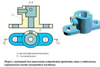
В зависимости от положения секущей плоскости относительно горизонтальной плоскости проекций разрезы разделяются:
