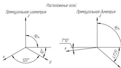
**Изометрическая проекция.** Коэффициент искажения по осям **X**, **Y**, **Z** равен 0,82. Изометрическую проекцию для упрощения выполняют, как правило, без искажения по осям **X**, **Y**, **Z** т.е. принимают коэффициент искажения равным единице.
