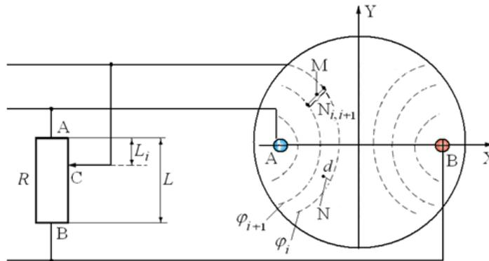
8. Определить потенциал и напряженность поля в 4-5 произвольно выбранных или заданных преподавателем точках для одного из смоделированных полей. В соответствии с выбранным масштабом и вычисленными значениями напряженности начертить в выбранных точках вектора  $\vec{E}$ .
