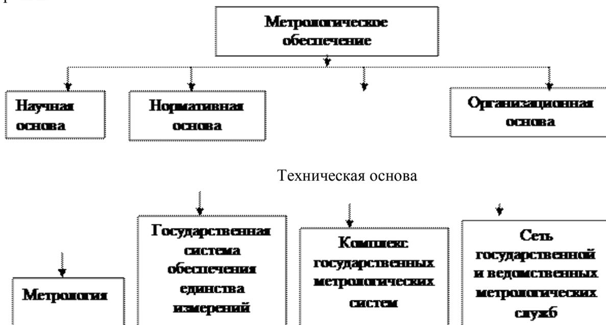
Рисунок 7 - Структура метрологического обеспечения измерений
