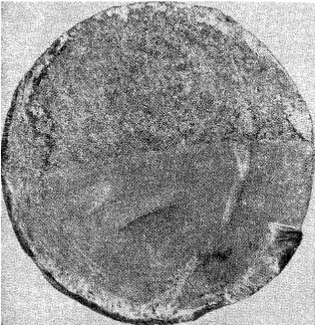
Рис.4. Характерные признаки усталостного разрушения
