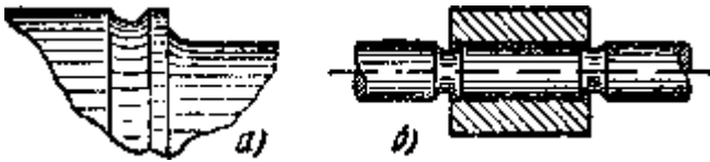
Рис.6. Конструкции разрушенных канавок — а), в том числе в местах посадок — б)
