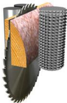
Рис. 18 Схема работы реброво-горбыльного станка а – горизонтального, б – вертикального
