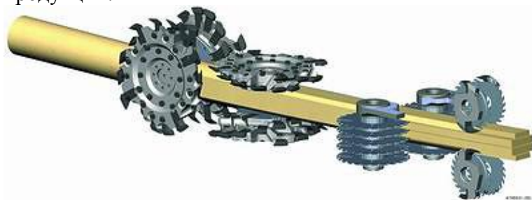
Рис. 17 Принцип работы фрезерно-профилирующего оборудования
