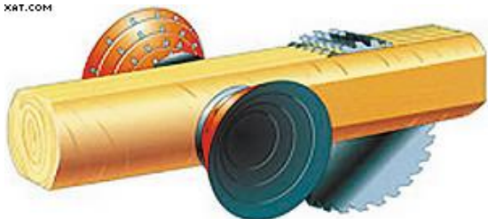
Рис. 16 Схема работы фрезерно-пильного оборудования
