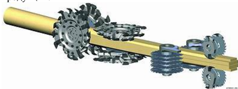
Рис. 17 Принцип работы фрезерно-профилирующего оборудования
