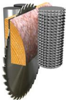
Рис. 18 Схема работы реброво-горбыльного станка а – горизонтального, б – вертикального
