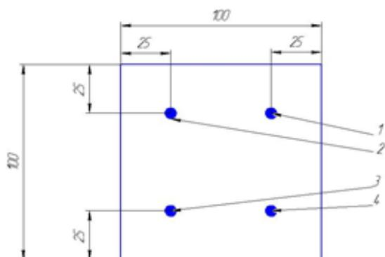
Рис. 1. Схема определения толщины плиты
