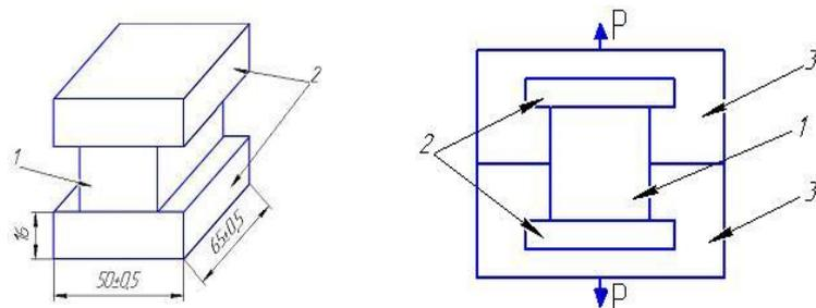
Рис. 3. Схема образца ДСтП и испытательного блока
