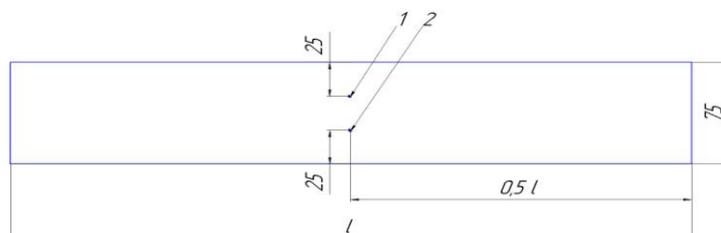
Рис..2. Схема образца ДСтП для определения предела прочности при статическом изгибе
