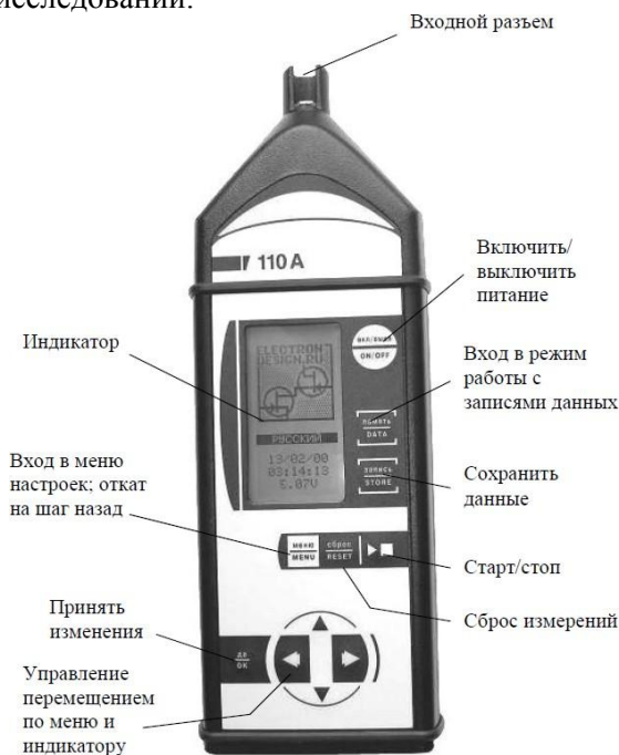
Рис. 3. Внешний вид и описание клавиш шумомера ОКТАВА-110А
