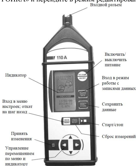
Рис. 3. Внешний вид и описание клавиш шумомера ОКТАВА-110А
