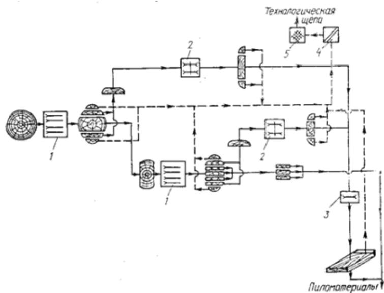
Рис. 1 Структурная схема потока для производства обрезных пиломатериалов
