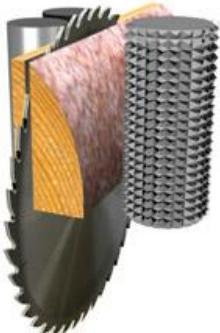
Рис. 18 Схема работы реброво-горбыльного станка
