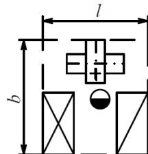
Рис. 76. Рабочее место станка ДЦА-3
