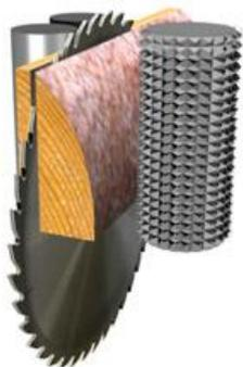
Рис. 18 Схема работы реброво-горбыльного станка
