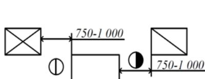
Рис. 108. Расстояние между станком продольного проходного типа и подстопными местами, мм
