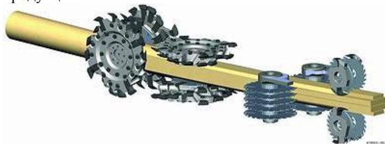
Рис. 17 Принцип работы фрезерно-профилирующего оборудования
