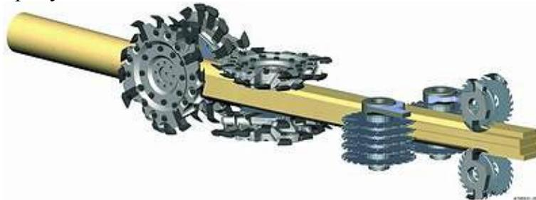
Рис. 17 Принцип работы фрезерно-профиiliрующего оборудования
