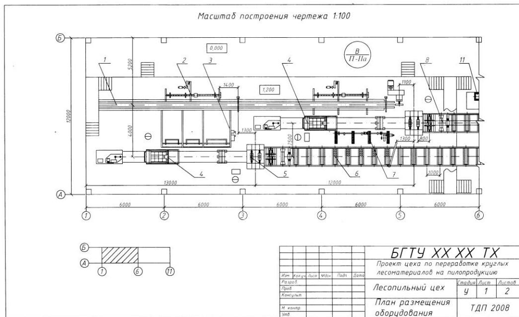
Рис. 1. Схема одноэтажного лесопильного цеха (участок лесопильных рам)
