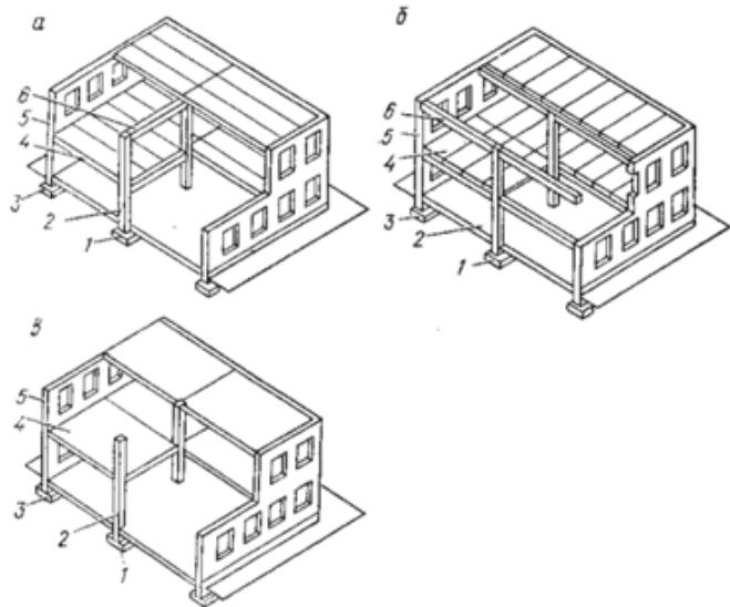
Рис. 27 – Конструктивные схемы зданий с неполным каркасом
