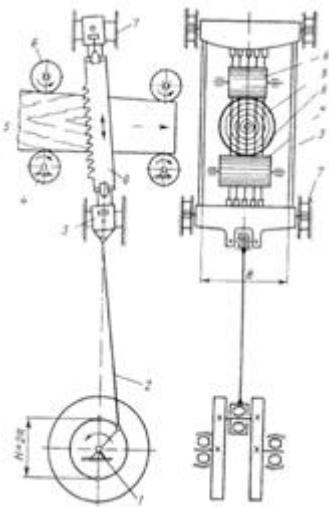
Рис. 9 Принципиальная схема устройства лесопильной рамы
