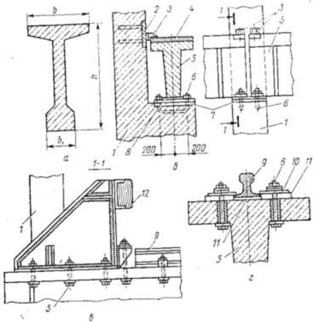
Рис.40 – Сборные железобетонные подкрановые балки
