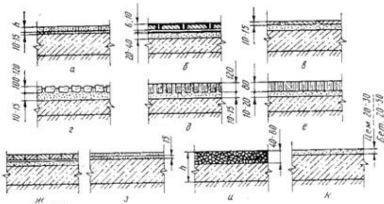
Рис. 45 – Полы производственных зданий
