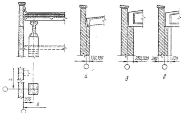
Рис. 30 – Привязка торцовой колонны и стены к поперечной разбивочной оси
