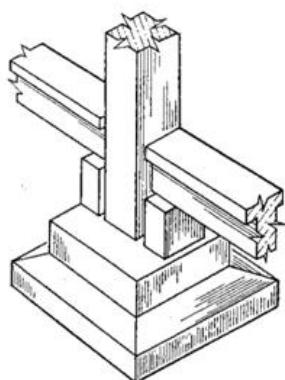
Рис. 39 – Схема опирания фундаментной балки на фундамент
