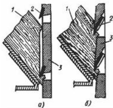
Рис. 22 Схема узлов резания дисковой рубительной машины
