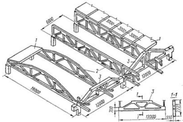
Рис. 42 – Фрагмент покрытия с различными стропильными фермами
