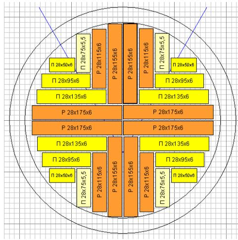
Рис. 14 Схема раскroя бревна для получения радиальных пиломатериалов
