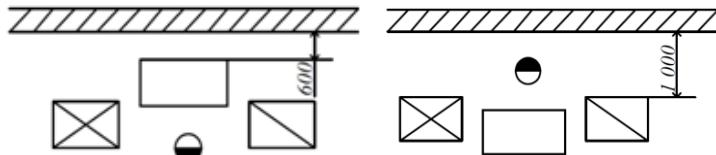
Рис. 105. Расстояние от тыльной стороны станка до стены или колонны цеха, мм
