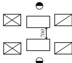
Рис. 107. Расстояние между тыльными сторонами станков, м
