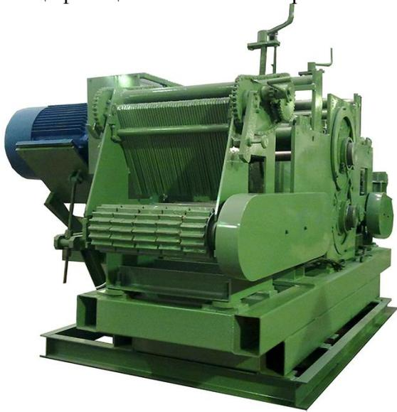
Рис. 11 Двухвальный круглопильный многопильный станок
