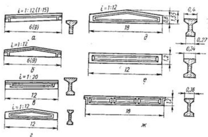
Рис. 41 – Сборные железобетонные стропильные балки
