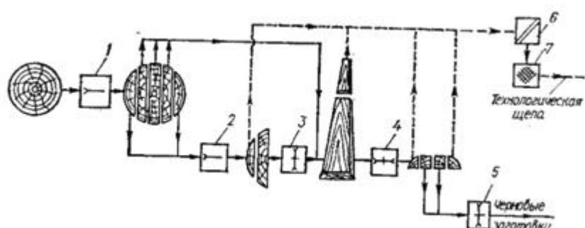
Рис. 5 Структурная схема потока на базе ленточнопильного станка для распиливания низкокачественного сырья лиственных пород на черновые заготовки
