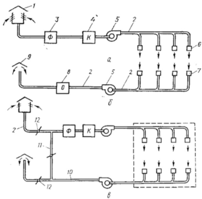
Рис. 125 – Схемы устройства механической вентиляции
