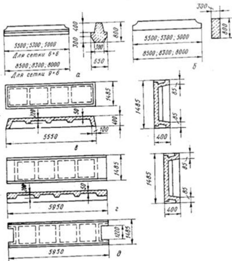
Рис. 43 – Конструкции ребристых перекрытий
