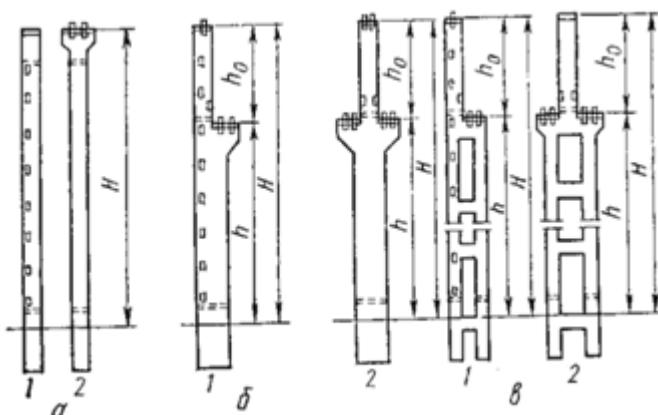
Рис. 38 – Железобетонные колонны
