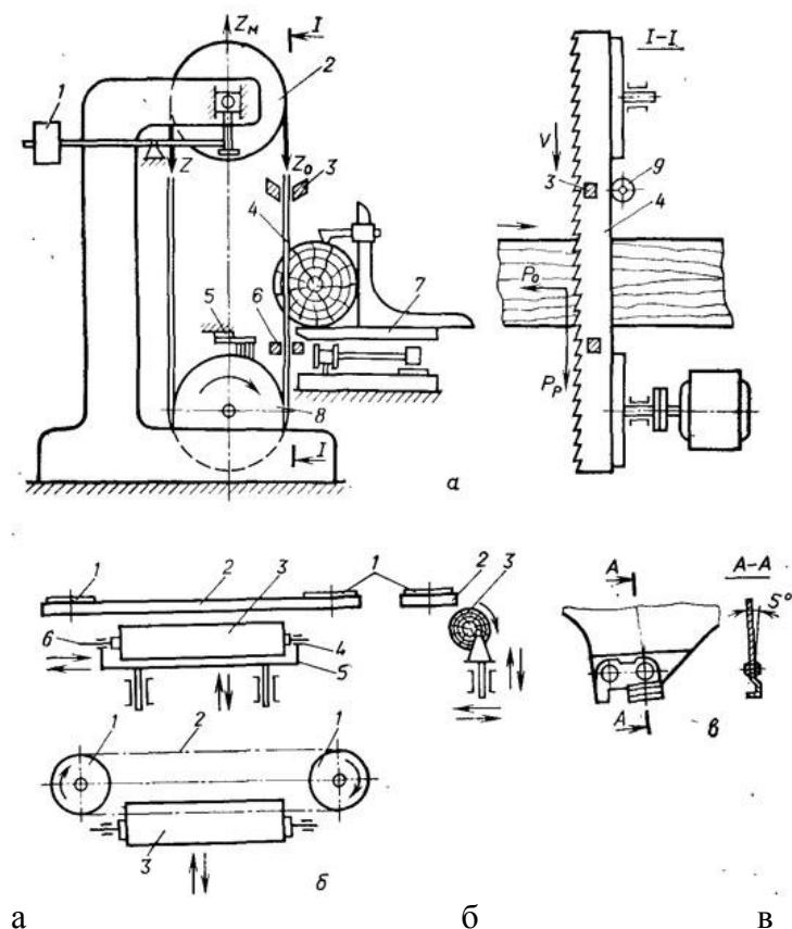
Рис. 10 Принципиальная схема работы ленточнопильного станка
