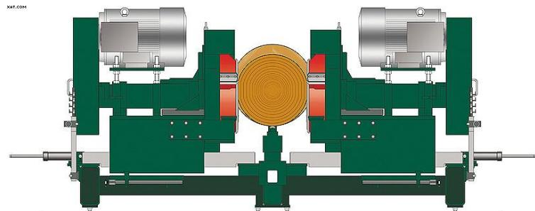
Рис. 15 Принцип работы фрезерно-брusующего оборудования
