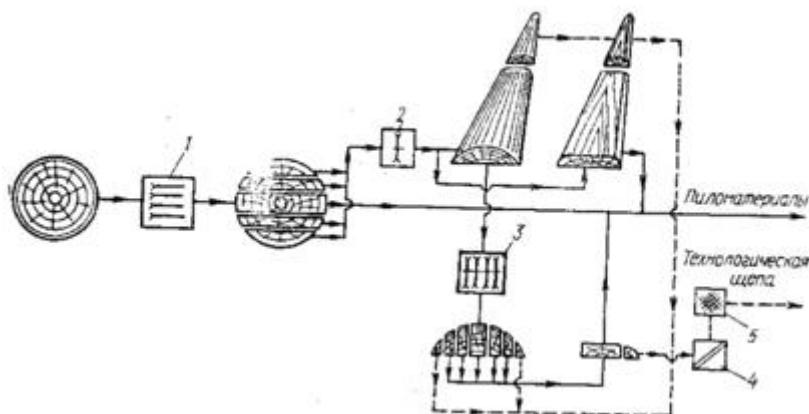
Рис. 4 Структурная схема потока для распиливания бревен твердых диставенных пород
