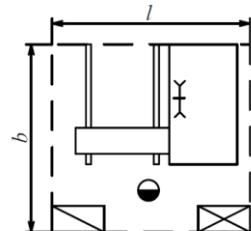
Рис. 52. Рабочее место станка Ц6-2(3) с кареткой
