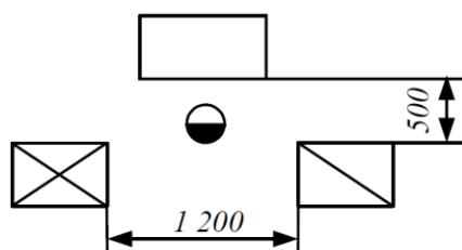
Рис. 112. Расстояние между станком и его подстопными местами
