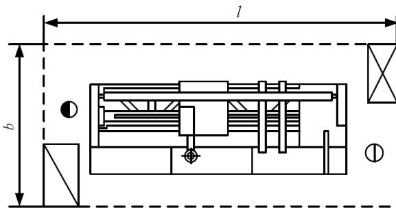
Рис. 96. Рабочее место станка ПТШ-1
