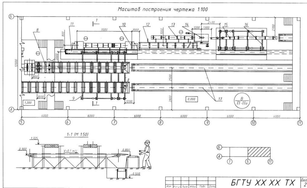
Рис. 2. Схема одноэтажного лесопильного цеха (участок торцовки и обрезки)
