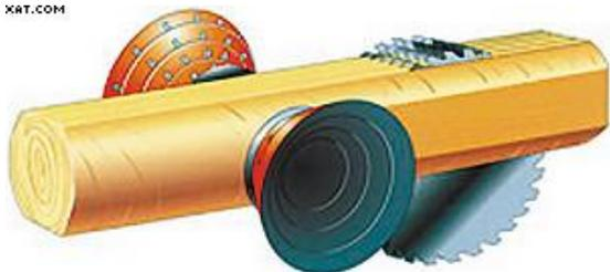
Рис. 16 Схема работы фрезерно-пильного оборудования
