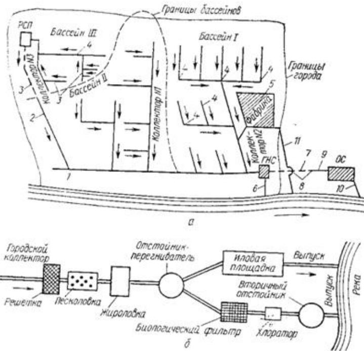
Рис. 127 – Схемы канализации населенного пункта и очистки сточных вод:
