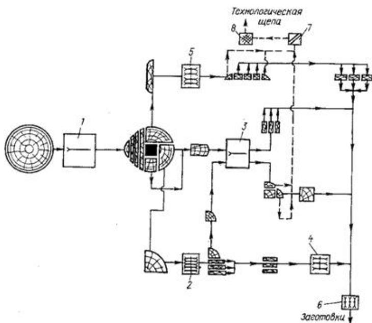
Рис. 2 Структурная схема потока для распиливания низкокачественных бревен на черновые заготовки на базе ленточнопильного станка
