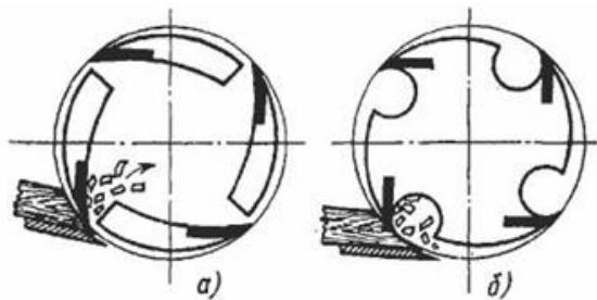
Рис. 21 Схема работы барабанной рубительной машины
