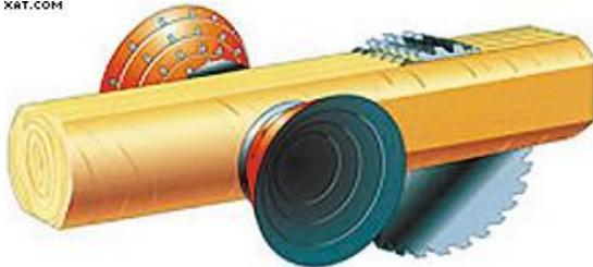
Рис. 16 Схема работы фрезерно-пильного оборудования
