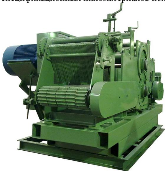
Рис. 11 Двухвальный круглопильный многопильный станок
