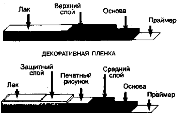
Рис. Структура многослойных пленок из модифицированного жесткого ПВХ
