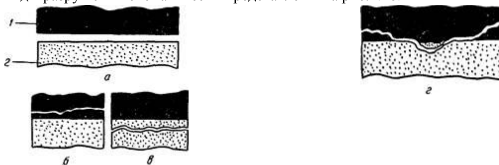
Рис. 4.16. Виды разрушений адгезионных соединений: а- адгезионное; б, в- когезионное; г- смешанное;
