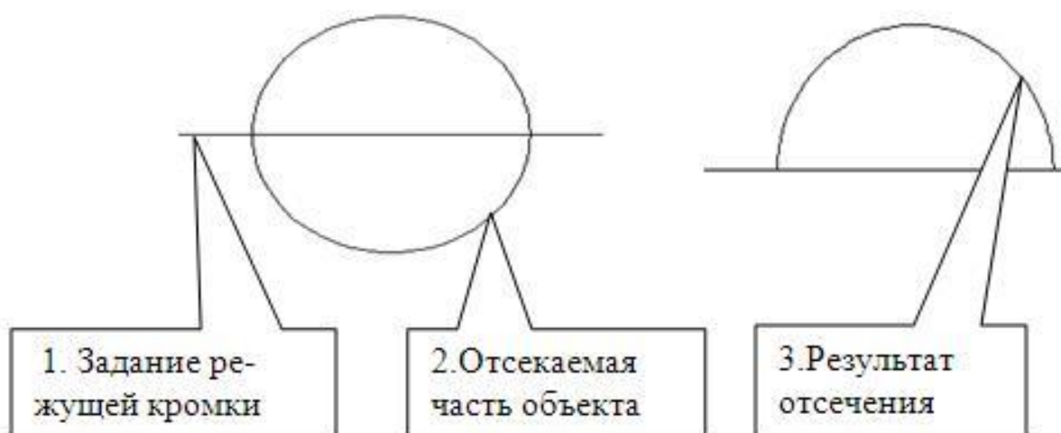
Рис. 2.10. Пример обрезки объектов
