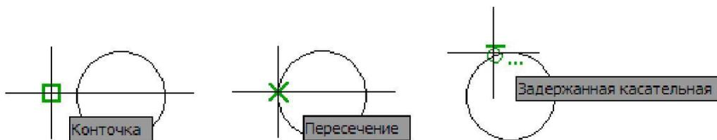
Рис. 2.6. Изображения курсора при различных режимах объектной привязки
