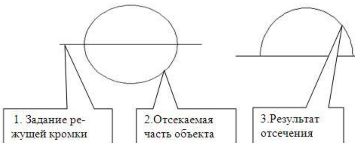
Рис. 2.10. Пример обрезки объектов
