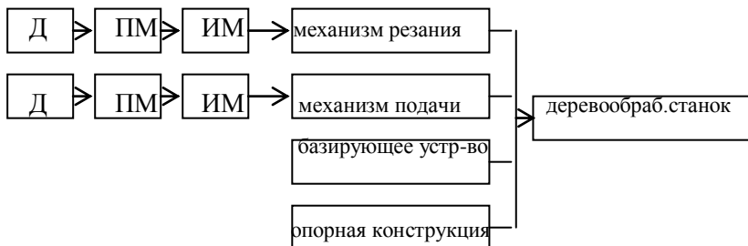
Рис. 1 Структурная схема механизированного деревообрабатывающего станка: Д – двигательный механизм; ПМ – передаточный механизм; ИМ – исполнительный механизм
