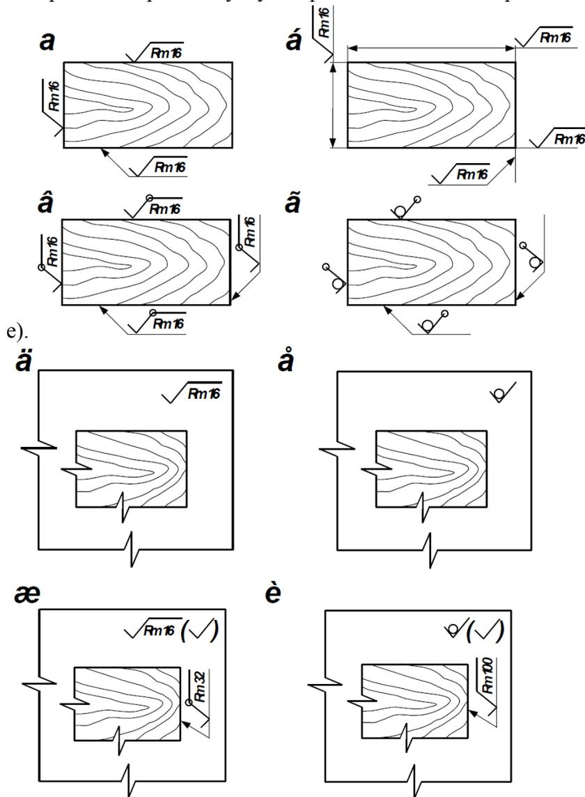
Рис. 3. Обозначение шероховатости поверхности на чертежах
