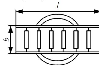
Рис. 1.58. Поворотное устройство
