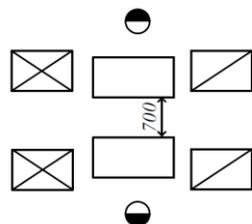
Рис. 1.60. Расстояние между тыльными сторонами станков, м
