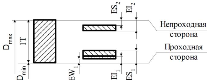
Рис. 4. Схема расположения полей допусков размеров калибров для отверстий
