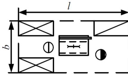
Рис. 1.2. Рабочее место станка ЦДК4-3
