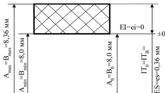
Рис. 4. Схема расположения полей допусков отверстия и вала
