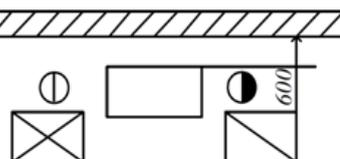
Рис. 1.62. Расстояние от боковой стороны станка до стены или колонны цеха, мм
