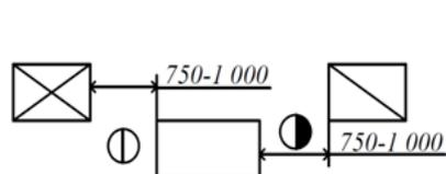
Рис. 1.61. Расстояние между станком продольного проходного типа и подступными местами, мм
