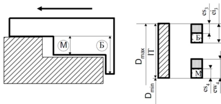
Рис. 7. Схема 2 измерения и расположения полей допусков размеров калибров для контроля глубин и высот уступов
