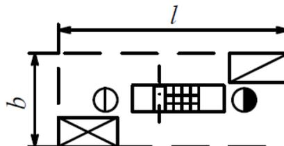
Рис. 1.14. Рабочее место станка СФ4-1
