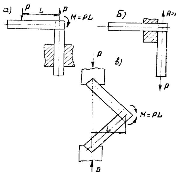
Рис.4.1. Схемы разрушения шиповых соединений
