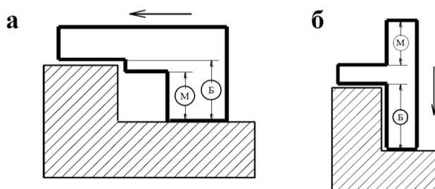
Рис. 3. Калибр-уступомер: а – односторонний двухпредельный;
