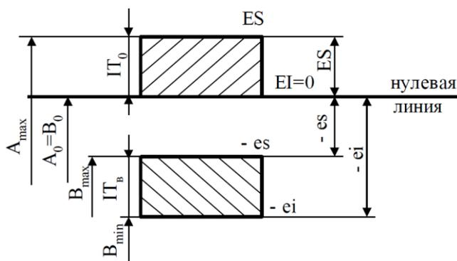
Рис. 1. Схема изображения полей допусков отверстия и вала
