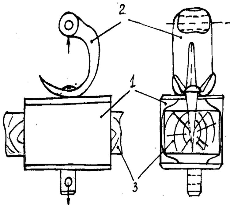
Рис.7.1. Схема испытаний шурупоудерживающей способности
