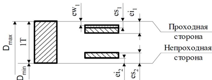
Рис. 5. Схема расположения полей допусков размеров калибров для валов
