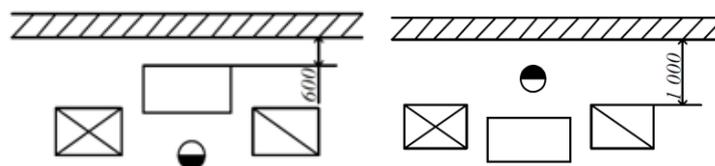
Рис. 1.58. Расстояние от тыльной стороны станка до стены или колонны цеха, мм
