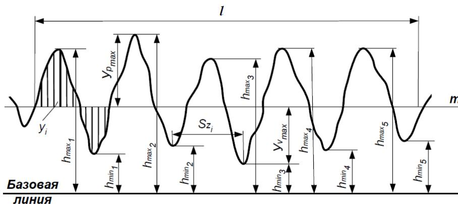
Рис. 2. Неровности профиля поверхности для определения параметров  $R_m$ ,  $R_z$ ,  $R_a$ ,  $S_z$
