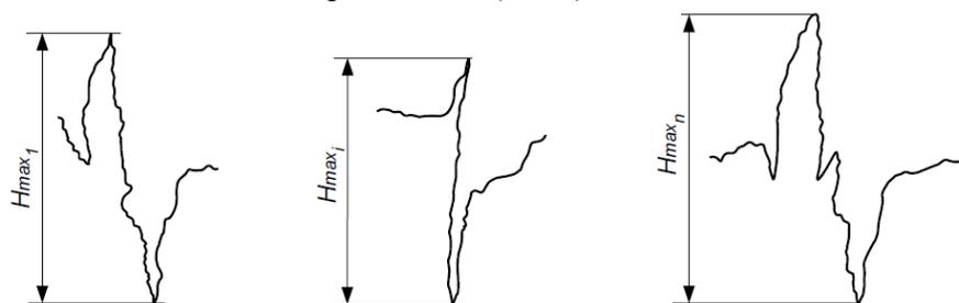
Рис.1. Наибольшие неровности поверхности для определения параметра  $Rm_{max}$
