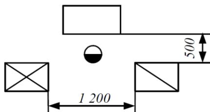
Рис. 1.65. Расстояние между станком и его подступными местами
