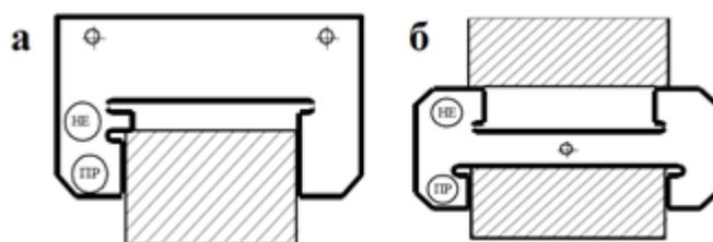
Рис. 1. Калибр-скоба: а – скоба односторонняя двухпредельная;
