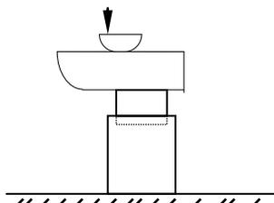
Рис. 3.1. Схема сборки шипового соединения
