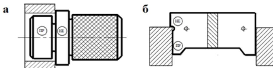
Рис. 2. Калибр-пробка: а – пробка односторонняя двухпредельная для контроля отверстий; б – пробка односторонняя двухпредельная для контроля размеров ящичных, дверных, оконных проемов по высоте и ширине
