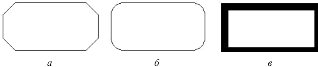
Рис. 1.16. Построение прямоугольника с использованием опций: а – Фаска; б – Сопряжение; в – Высота и Ширина
