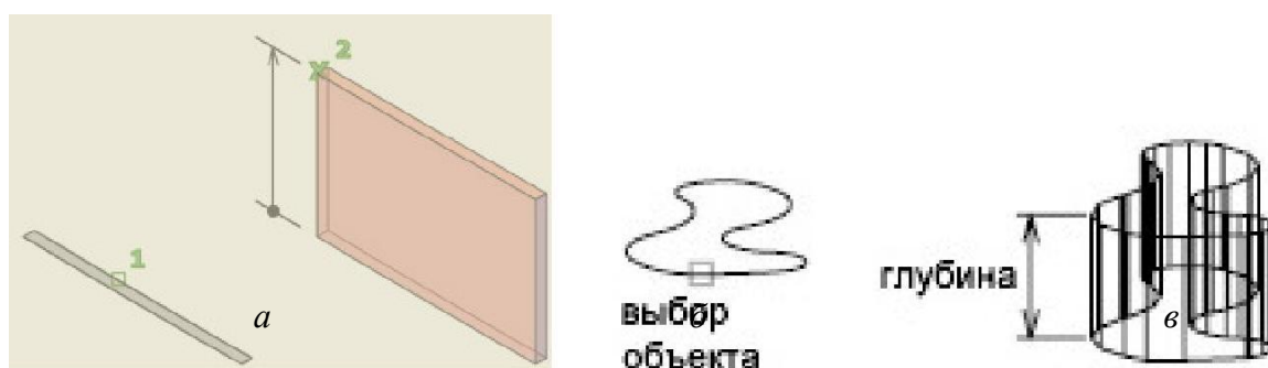
Рис. 5.12. Построение тела с использованием команды Выдавить : а – порядок указания точек при реализации команды; б – выбор объекта для выдавливания; в – глубина выдавливания
