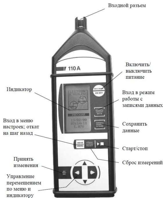
Рис. 3. Внешний вид и описание клавиш шумомера ОКТАВА-110А
