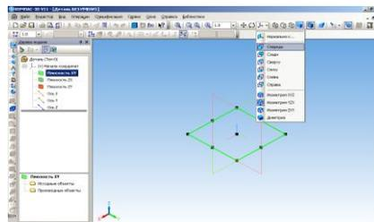
Рис 4 Диалоговое окно установки глобальных привязок      Рис 5 Выбор плоскости проекций
