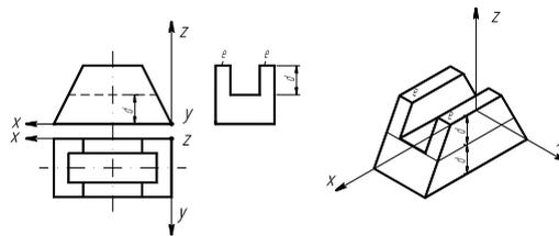
Рис. 9. Чертёж и изометрия предмета с продольным пазом.
