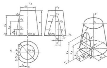
Рис. 13 Построение стандартной прямоугольной диметрии прямого кругового цилиндра
