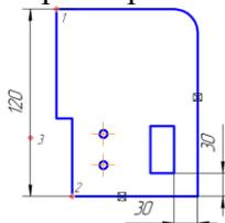
Рисунок 9 Порядок нанесения размеров
