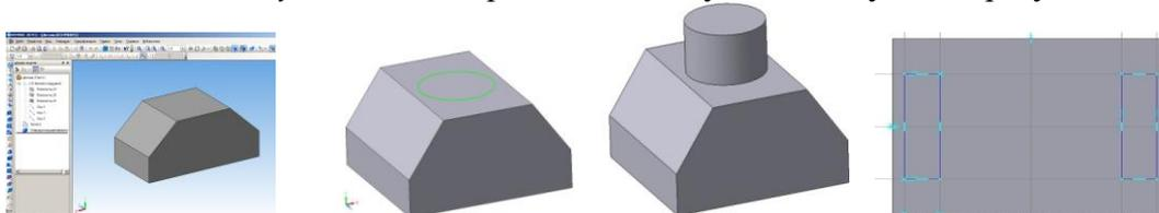
6 Выполняем добавление на верхней части детали цилиндрической формы это осуществляется при помощи команды «*Приклеить выдавливанием*». Для этого выбираем верхнюю плоскость для создания эскиза в виде окружности.
