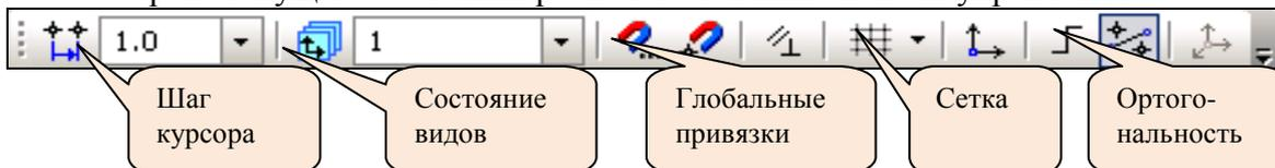
В этой строке отражаются параметры текущего состояния КОМПАС-3DV13 шаг курсора, состояние видов, глобальные привязки, запретить привязки, параметрический режим, сетка, локальная система координат, ортогональность, скругление, а так же некоторые управляющие кнопки.
