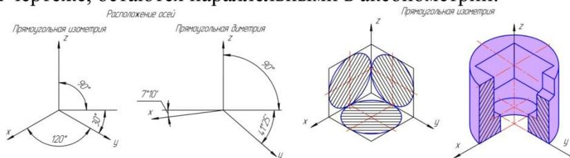
**Изометрическая проекция.** Коэффициент искажения по осям *X*, *Y*, *Z* равен 0,82. Изометрическую проекцию для упрощения выполняют, как правило, без искажения по осям *X*, *Y*, *Z* т.е. принимают коэффициент искажения равным единице.
