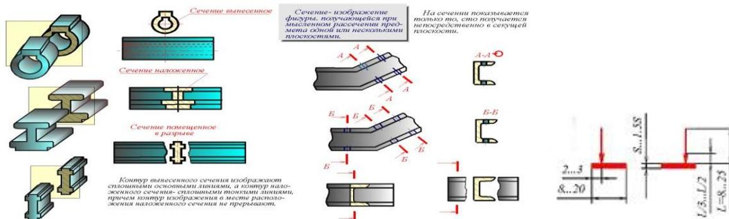
Положение секущей плоскости указывают на чертеже линией сечения. Для линии сечения применяют разомкнутую линию со стрелками указывающими направление взгляда и обозначают секущую плоскость одинаковыми прописными буквами русского алфавита. Сечение сопровождается надписью по типу А-А.
