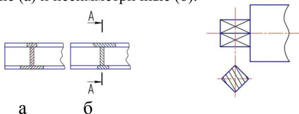
Если секущая плоскость проходит через сквозное некруглое отверстие и сечение получается состоящим из отдельных самостоятельных частей, то вместо сечения следует выполнять разрез.
