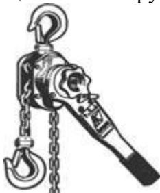
*Ручные тали* представляют собой простейшие подъемные устройства из нескольких подвижных и неподвижных блоков, огибаемых цепью. Редуцирующим звеном в таях являются обычно червячная или зубчатая передача, а также канатный или цепной полиспаст. Тали подвешивают к козлам, балкам и т.д. Для горизонтального перемещения груза таль может быть подвешена к тележке, передвигающейся вручную по монорельсу.
