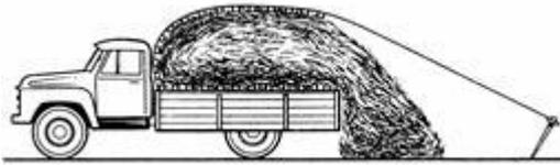
Перед погрузкой груза щит устанавливают вплотную к переднему борту, а сетку расстилают по всей площади платформы и закрепляют со стороны заднего борта. К свободным концам сетки или щиту крепятся канаты, которые в местах выгрузки груза привязывают к надежным упорам. При движении автомобиля вперед находящийся в кузове груз сбрасывается щитом или сеткой.
