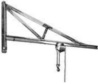
*Консольные ручные краны* используют для выполнения ПРР со штучными и тяжеловесными грузами, а также и контейнерами в пунктах с небольшим объемом работ.
