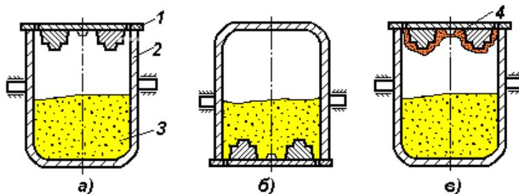
Рис. 2.7. Изготовление оболочковой формы
