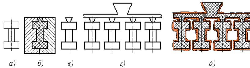
Рис. 2.8. Изготовление литейной формы методом выплавляемых моделей
