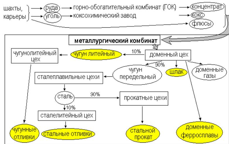
Рис. 1.1. Схема металлургического производства (чёрная металлургия)
