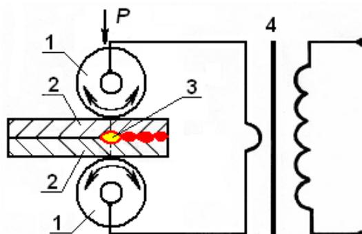
Рис. 4. 6. Схема шовной (роликовой) электроконтактной сварки
