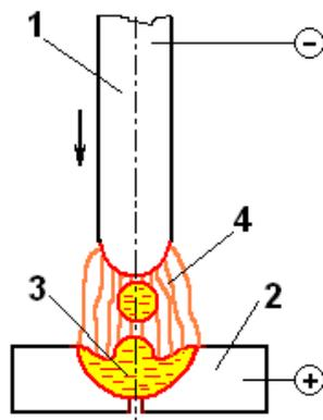
Рис. 4.1. Схема сварочной дуги постоянного тока: 1 – электрод;
