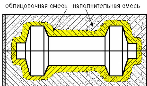
Рис. 2.3. Заполнение формы облицовочной и наполнительной смесью
