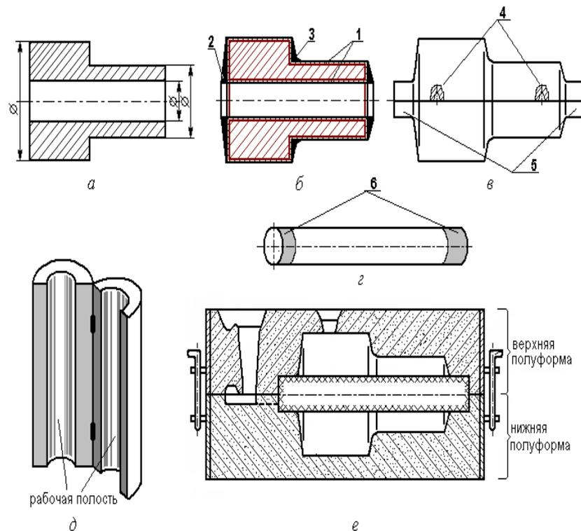
Рис. 2.5. Последовательность изготовления отливки:
