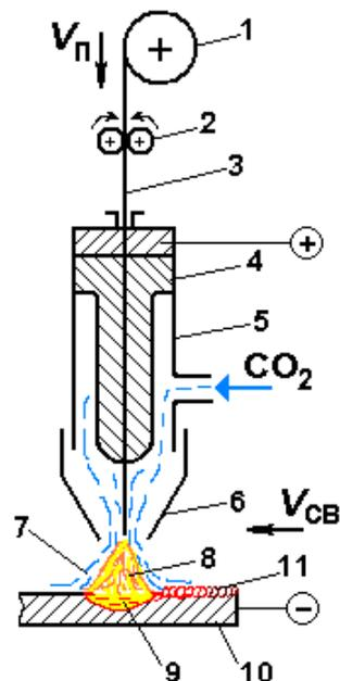
Рис. 4.4. Схема сварки в углекислом газе: 1 – кассета с проволокой; 2 – механизм подачи; 3 – проволока; 4 – токоподводящий мундитук; 5 – корпус горелки; 6 – сопло; 7 – атмосфера защитного газа; 8 – дуга; 9 – ванна жидкого металла; 10 – свариваемый металл; 11 – шов
