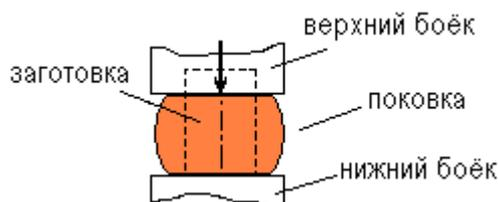
Рис. 3.7. Схема ковки (осадки)
