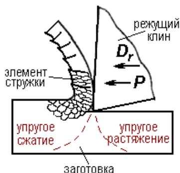
Рис. 5.1. Процесс образования стружки
