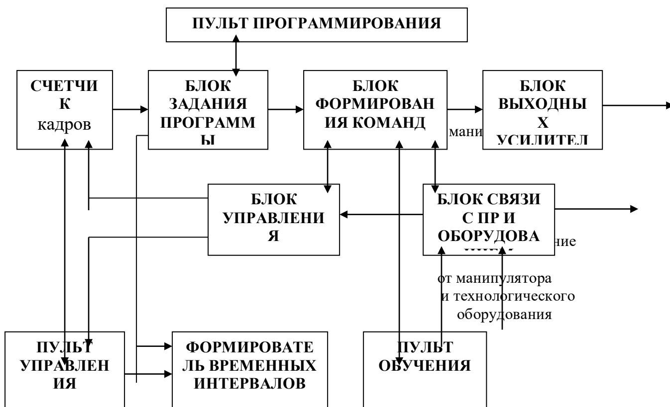
Рисунок 7 Структурная схема устройства УЦМ-30.
